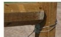
2. Druhým krokom je potom namontovanie drôtu ozubeného kolieska napínačom pomocou integrovanej slúčky na samom spodku rohového stĺpika a polohu zaistite pomocou svorky.
